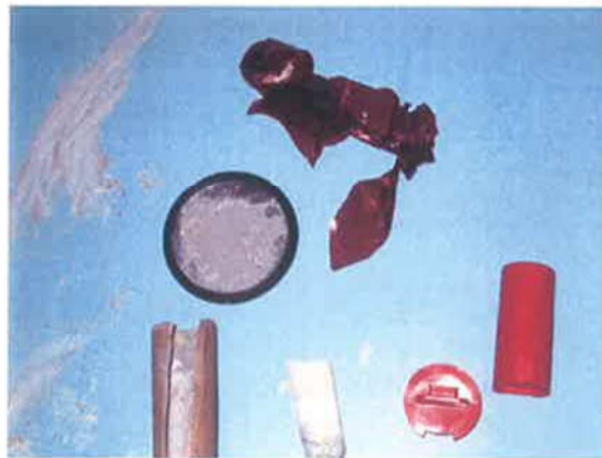
Figuur 3 Ontsteker in FKO met Pyrotechnisch mengsel
